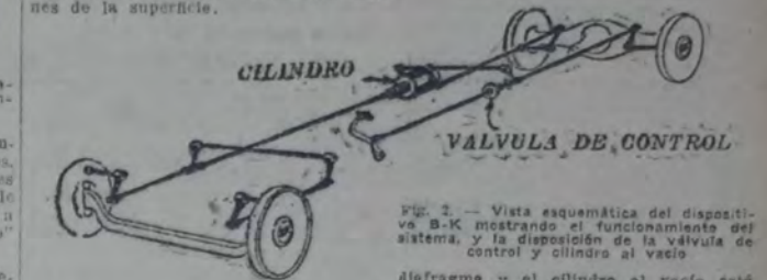
Fig. 2. — Vista esquemática del dispositivo B-K mostrando el funcionamiento del sistema, y la disposición de la válvula de control y cilindro al vacío.
